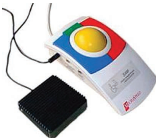
Εικόνα 3: Παράδειγμα ιχνόσφαιρας: Η συσκευή έχει πολλά κοινά με το γνωστό ποντίκι, αλλά στην ουσία είναι ένα αντεστραμμένο ποντίκι. Αντί να έχει τη μπίλια από κάτω, την έχει από πάνω και ο χρήστης γυρνά απευθείας με τα δάκτυλά του τη μπίλια αντί να κινεί τη συσκευή (ορισμός από δίκτυο [ΕΥΤΕΧΝΟΣ]).
