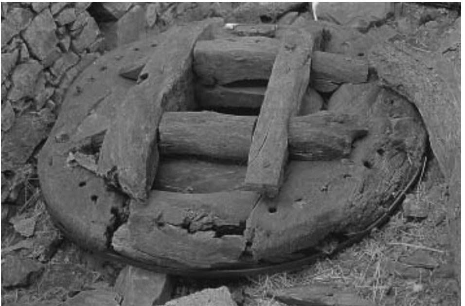
Πιν. 38β: Νοφαλιάς: ο οδοντωτός τροχός από τον δεύτερο, γκρεμισμένο μύλο στον παλιό δρόμο του Αμυγδαλιά.
